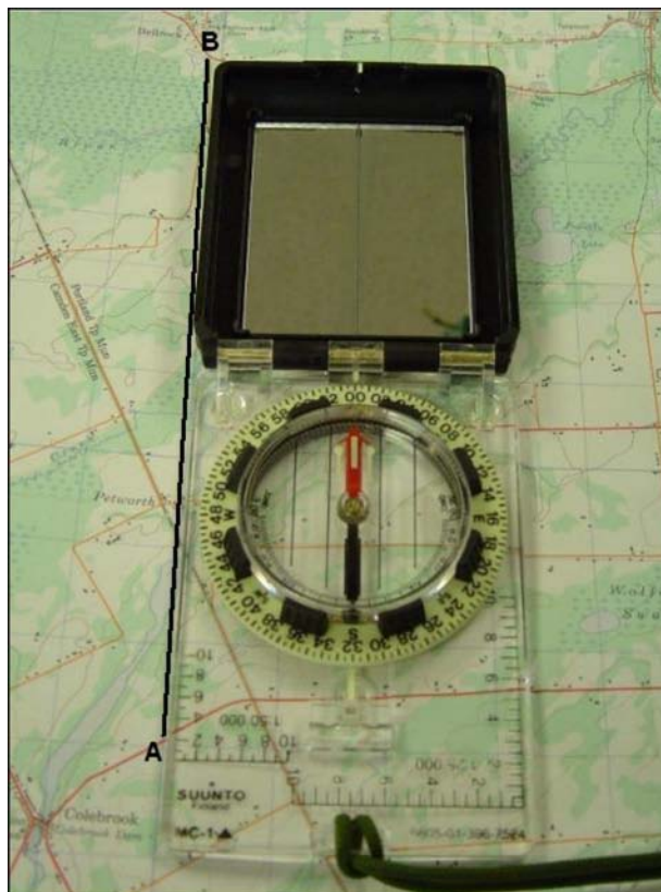
Figure 12-6-2 Mesurer un azimut magnétique sur une carte
